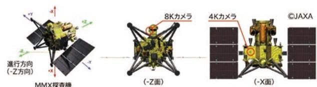
図1 スーパーハイビジョンカメラの搭載位置
